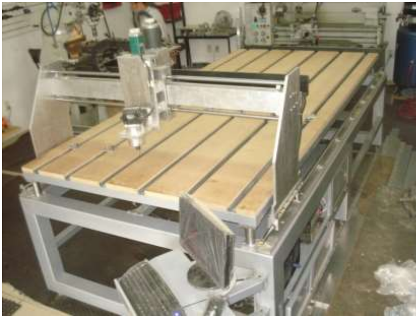
Router CNC. Fresas e cortes em placas rígidas
