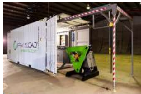
Maquina FRAMECAD com todo o aparato produtivo dentro do container, para fabricarr os perfis em Steel Frame A maquina pode ser transportada por caminhão dentro deste container
